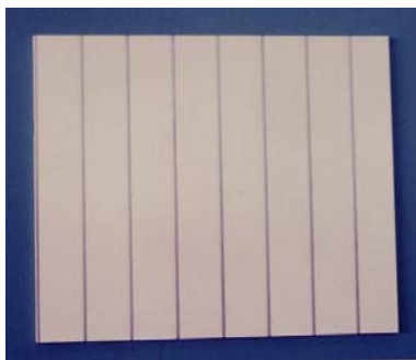
図2 セラミック製電界カーテンパネル (100mm W x 120mm L)
